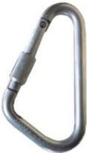
предназначен для страховки пожарного при работе на высоте, а также для спасения и самоспасания людей с высотных уровней. Замковое соединение обеспечивает достаточную прочность конструкции карабина. Замыкатель и затвор обеспечивают работоспособность карабина при выполнении работ со спасательной веревкой.
