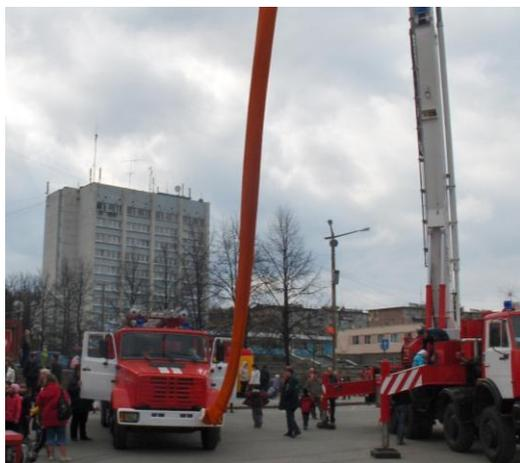
Автолестница - спасательное средство и средство подачи огнетушащих веществ в зону горения. Спасательная люлька, закреплённая на стреле, удобна для пожарных. В люльке предусмотрен люк для закрепления спасательного рукава и лифт на два человека. Управление автолестницей осуществляется с любого из трёх пультов: основного пульта управления, с пульта расположенного в люльке, а также выносного на расстоянии до 5 метров.
